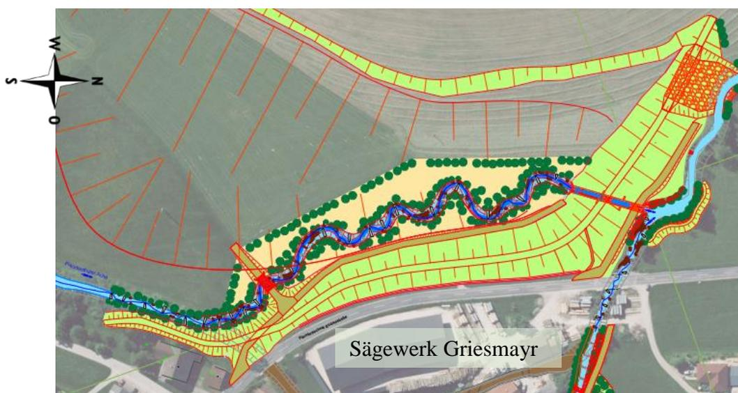
Abbildung 1: Auszug aus dem wasserrechtlichen Einreichprojekt, Bereich Rückhaltebecken
